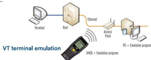
Der 8400er emuliert Terminals VT100, VT220 und TN5250. Ein großes, helles Display, funktionsgerechte alphanumerische Tastatur und verlängerte Akkulaufzeit gewährleisten, dass die Kraft der Terminalemulation jederzeit zur Verfügung steht.
